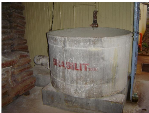
Figura 52: Estoque de cal e tina de preparação da solução.
