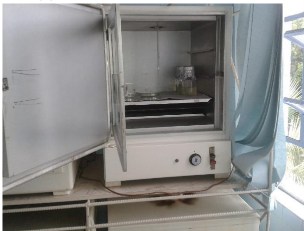
Figura 48: Estufa para análises microbiológicas.
