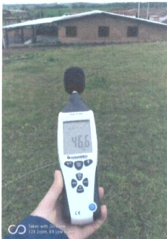
Figura 15 - Equipamento utilizado para a medição de ruídos.
