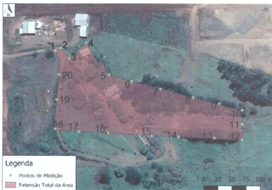
Figura 14 - Pontos de medição de nível de ruído.
